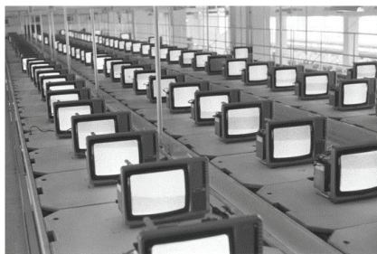
▲ 我国第一条彩色电视机生产线1980年在国营天津无线电厂建成并投入试生产。这是试生产装配的彩色电视机在通过老化检验。(新华社记者李昌元摄)
